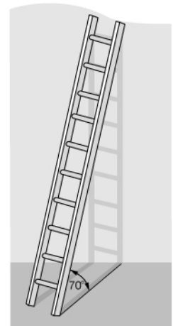
Rys. 5. Dobór właściwego pochylenia drabiny – kąt 70°
